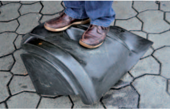
Die Front besteht aus dem superfesten PDCPD
