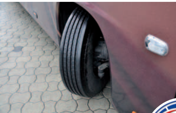
Volle 60 Grad beträgt der Radeinschlag
