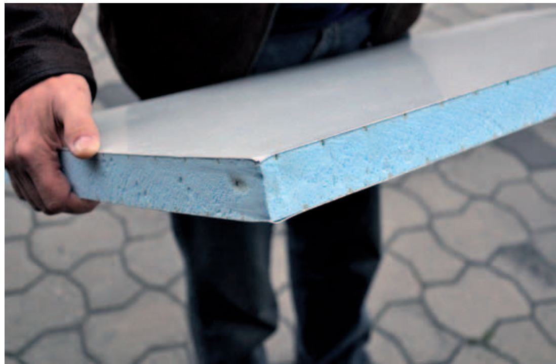
Wesentlich für das geringe Gewicht ist die stabile Dachstruktur in Sandwich-Bauweise
