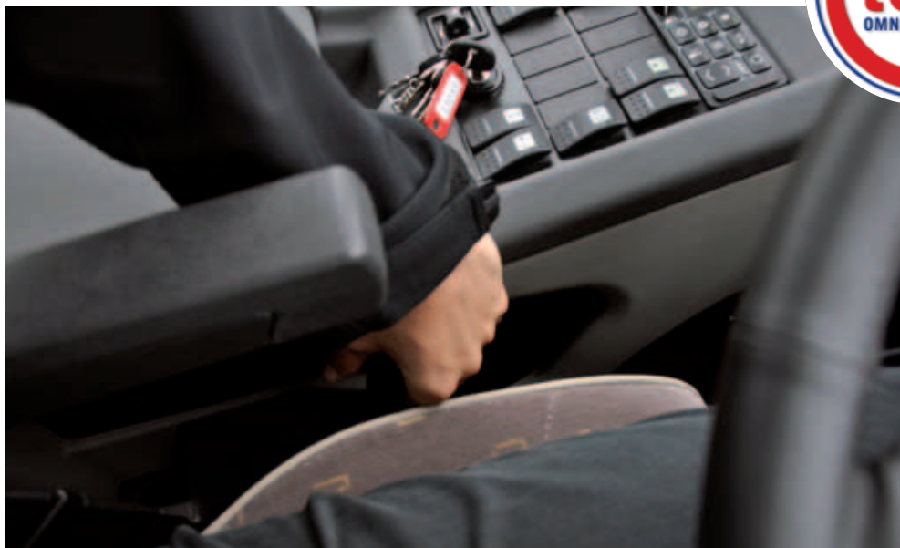
Kaum zu erreichen ist der Handbremshebel, wenn die Armlehne nach unten geklappt ist
